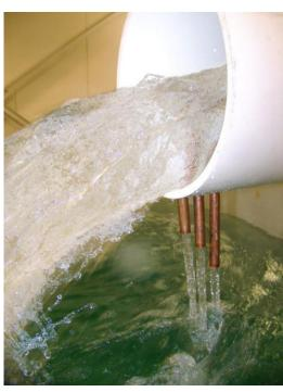
Figure 6 Scour Effluent Sampling Point
